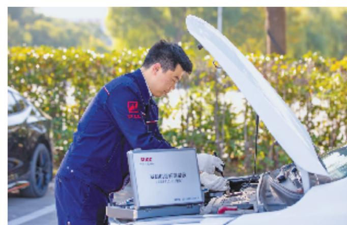
人保财险浙江嘉兴市分公司工作人员正在为客户车辆排除故障,使用定制设备(发动机连杆测量仪)检查发动机内部连杆有无弯曲、车辆是否正常行驶。(图片由人保财险浙江省分公司提供)
