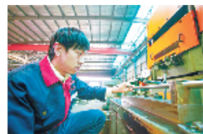
浙江洲供应链管理有限公司专业技术人员正在检验材料直线度以及跳动情况。
