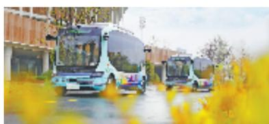
棒球未来社区自动驾驶亚运公交专线全长5.7公里，线路车辆采用L4级无人驾驶技术，除具备人车避让、自动变道、自动转向、精准停靠、红绿灯识别等基础功能外，还能根据后车加塞、人车混杂等城市复杂交通场景，进行动态避障、自主超车等操作。
