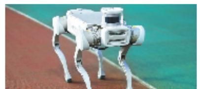
智能巡逻机器人头上的摄像头就像敏锐的眼睛,随时记录周边环境;四足行进的步态设计,让它拥有强大的全地形适应能力;可见光、热成像双谱云台等技术的助力,让它在夜间或人员密集等复杂环境中,拥有动态避障、三维地形重建等功能,实现巡防工作无死角。
