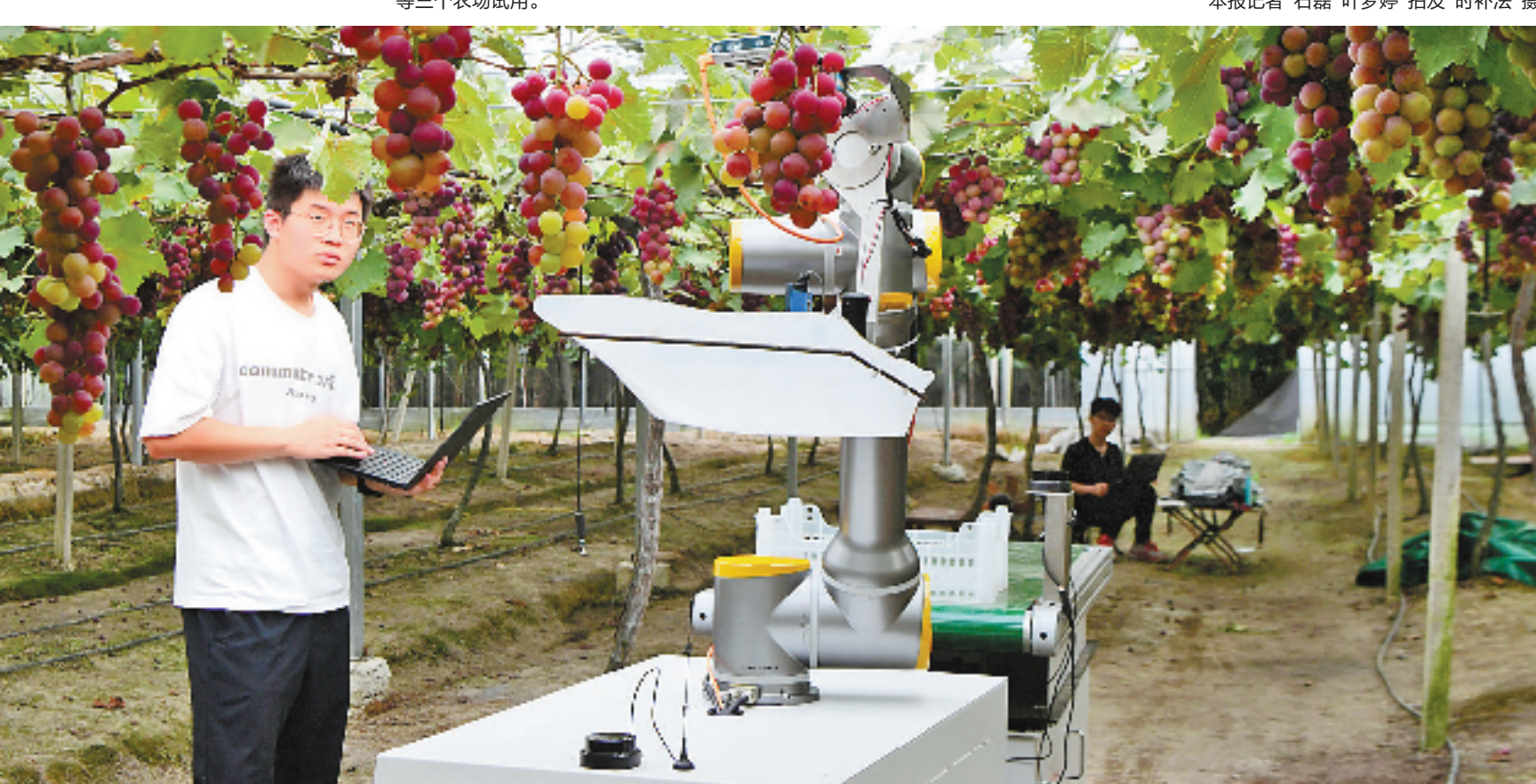
时下,正是浦江葡萄采摘旺季,一台由杭州自动化技术研究院研发的智慧葡萄采摘机器人穿梭田间。机器人“剪刀手”可以精准定位每一串葡萄,无损判断葡萄成熟度甚至甜度后决定是否采摘,并不受时间限制高效采摘。目前,智慧葡萄采摘机器人已经在浦江枫松、圣炫、大潘等三个农场试用。
