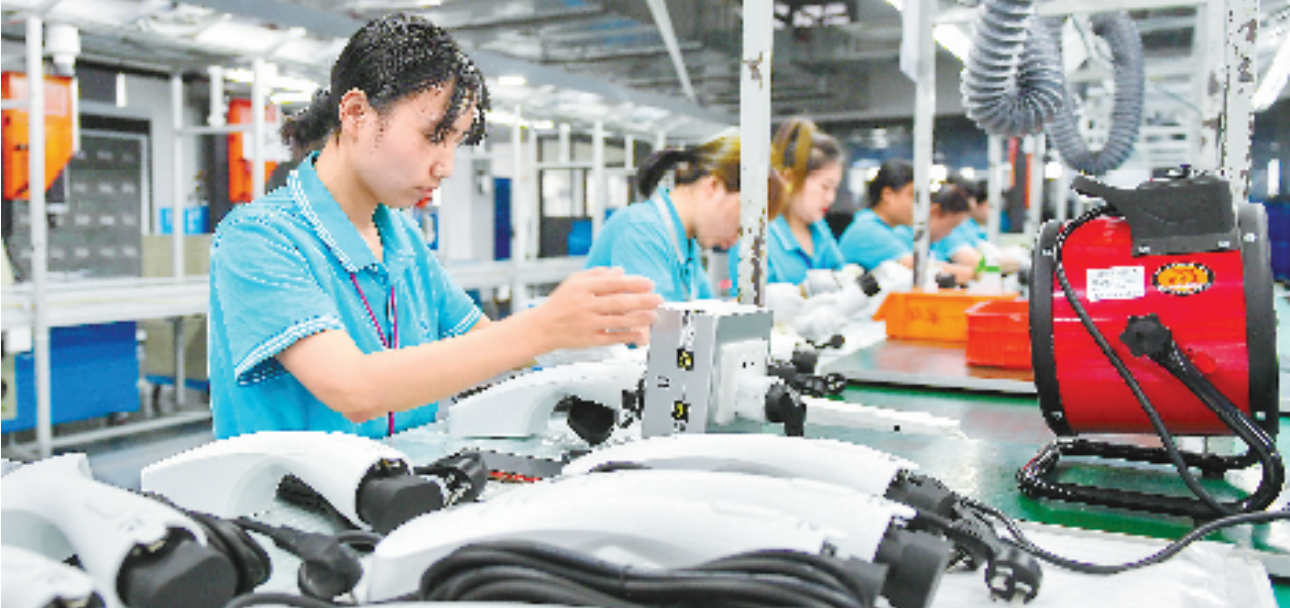
7月24日，位于长兴经济技术开发区的长兴博泰电子科技有限公司，工人在赶制便携式智能充电枪。这种便携式智能充电枪不仅方便随身携带，而且可以随时随地直接通过220V普通插座为新能源汽车充电。
