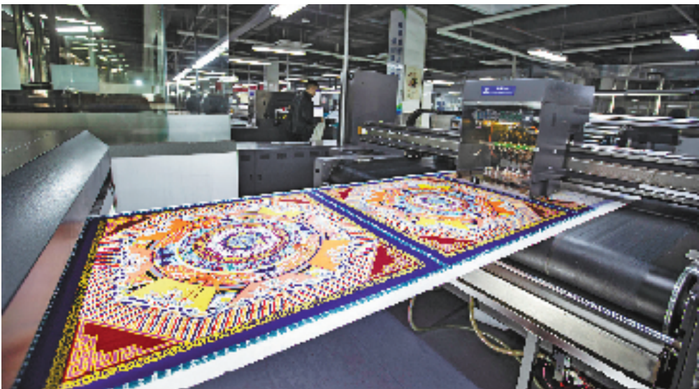
在万事利双面印花车间,人工智能数码印花技术让染料均匀牢固地“贴”到丝巾上。
