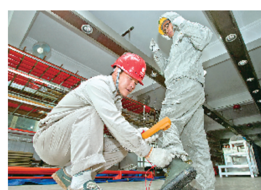
蒋卫东正在工具库房对带电作业屏蔽服进行电阻测量。 王平 摄
