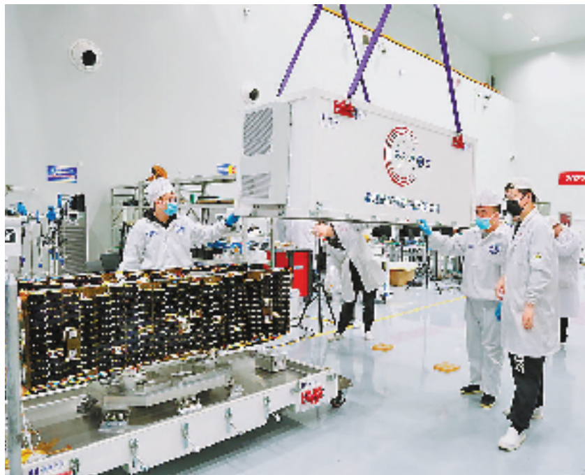
乾坤一号整星装配完成后进行装箱,准备转运至测试场地。
