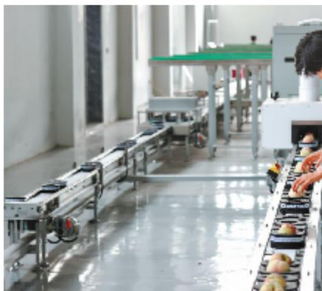
这两天,在嘉兴市南湖区凤桥镇,工人正忙着将水蜜桃放置在智能分拣流水线进行品质检测分类。据了解,该流水线除了能筛选出水蜜桃的分量、外观外,还能辨别水蜜桃的甜度,并根据前期设定数据,自动将水蜜桃筛入不同品级流水线进行后续包装。
