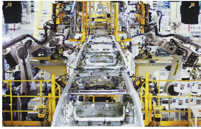
智能机器人在领克汽车宁波余姚工厂焊装车间工作。
