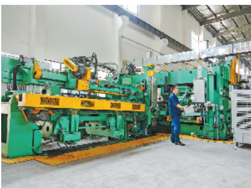
浙江裕荣弹簧有限公司车间内,自动热卷卷簧机正在作业。
