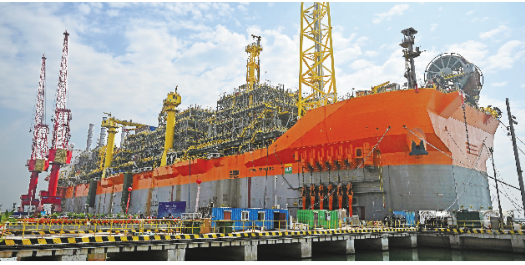
6月12日,海上浮式生产储卸油船(FPSO)“SEPETIBA”轮在天津完成交付并将于近日离港启运巴西。“SEPETIBA”轮总长333米,总高64米,总宽60米,储油能力达200万桶,最大排水量45万吨,可实现海上石油、天然气等能源的开采、加工、储存、外运,被称为“海上油气巨无霸”,是开采深海油气资源的高端大型海洋工程装备。
