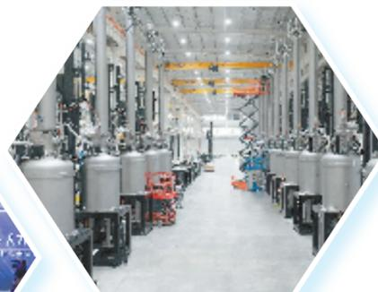
晶盛机电产业园单晶生长炉装配车间
