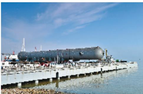
4月5日,由中石化下属宁波天翼制造公司承制的烟台万华高性能新材料一体化项目产品分离塔,从象山港西泽码头启运发往烟台。这个长138.6米、直径10.8米、重2558吨的“大块头”,体积相当于1000辆汽车,对制造工艺和安全质量要求严苛。这一“宁波制造”刷新了全球整体制造、整体运输、整体交付的分离塔长度的纪录。本报记者 王凯艺 拍友 张见明 张超梁 摄
