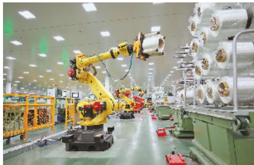
巨石成都智能制造基地检装车间内,一排排玻纤纱团被机械手臂快速有序地放在流水线上。
