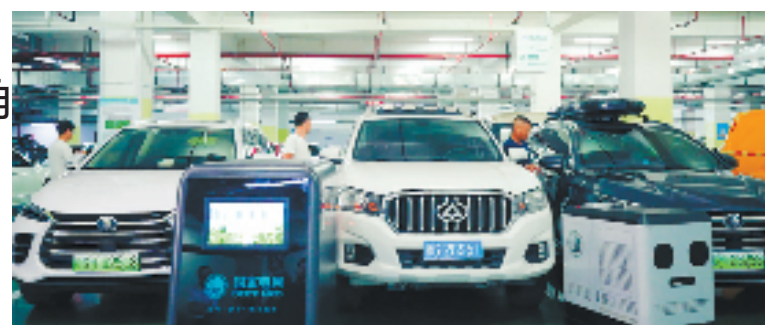
国网金华供电公司推出的吸顶式、滑轨式充电桩以及智能充电机器人等新型充电产品
