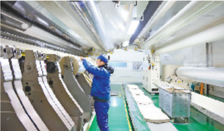
1月28日,在宁波市鄞州区宁波大东南万象科技有限公司,工人正在切割超薄电容器薄膜。这种微米级的薄膜产品在特高压智能电网、新能源汽车等领域应用广泛。
