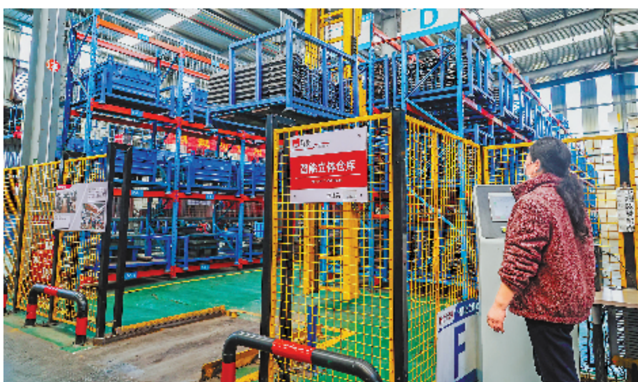
在浙江海蜜机械有限公司,1个人1台电脑就能管理智能化立体仓库。
