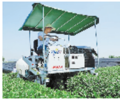
乘用型复合摘采机 (图片由余杭区畜牧农机发展中心提供)
