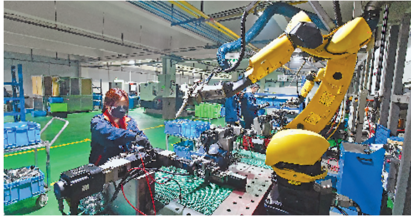
这几天，位于建德市航头镇工业功能区的杭州沈氏节能科技股份有限公司生产车间里，工作人员正在赶制焊接换热器配件等订单产品。
