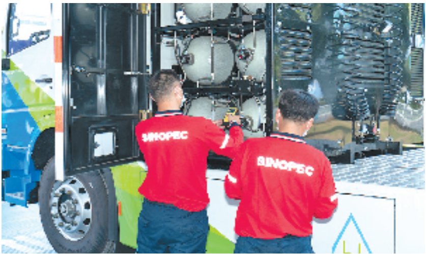
在嘉兴港区滨海大道加氢站,工作人员正在检查氢罐。
