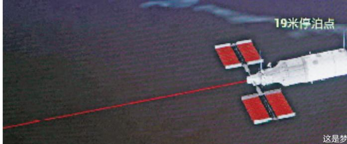
这是梦天实验舱从19米停泊点向天和核心舱前向端口靠近的模拟图像。 新华社发(孙丰晓 摄)
