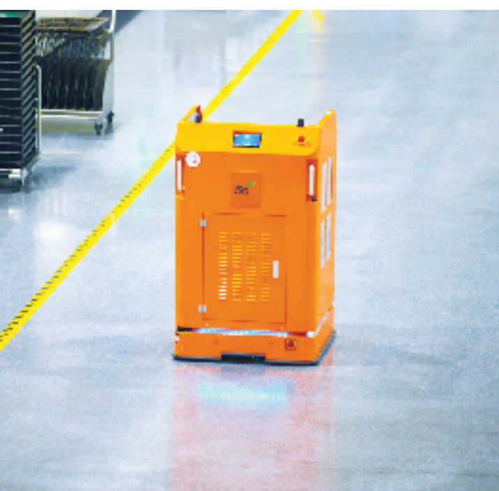
基于5G专网覆盖，AGV小车在紫光恒越工厂内自动运行。
