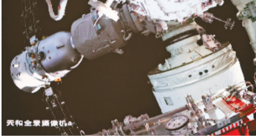
9月30日在北京航天飞行控制中心拍摄的问天实验舱转位画面。这是问天实验舱采用平面转位方式完成转位并与节点舱侧向端口再对接。
