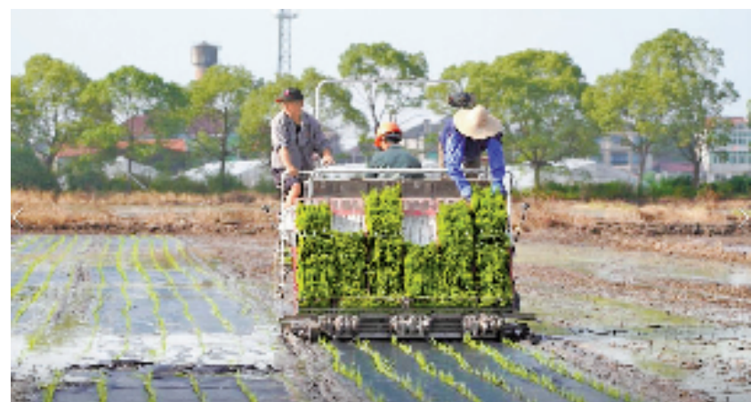
蔡建良的稻田用黑膜覆盖机插秧新技术进行插秧。 共享联盟新丰镇微融站供图
