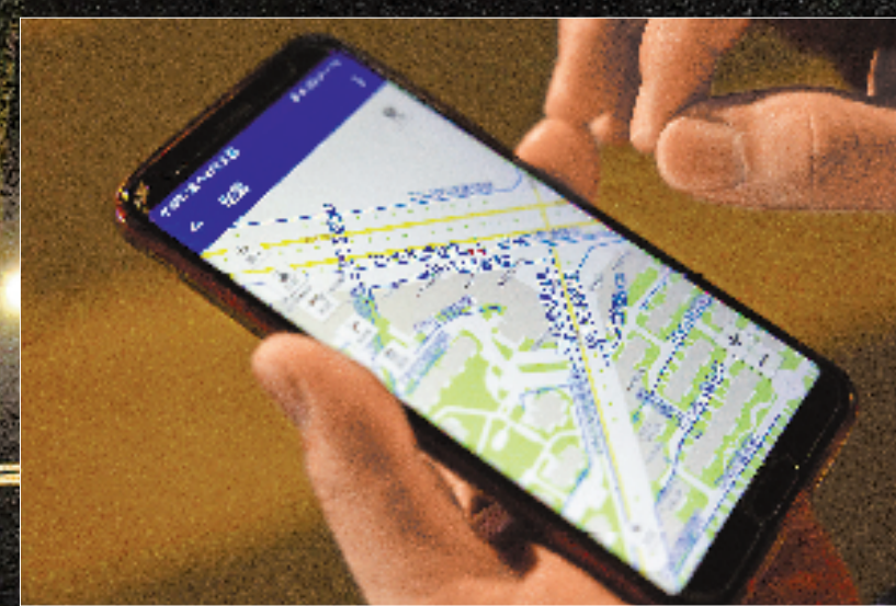
听漏工通过定位系统确认地下供水管网。
