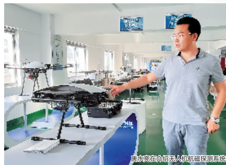
唐水亮在介绍无人机航磁探测系统。
