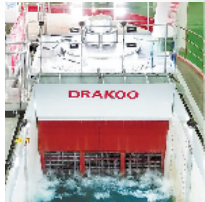
“绝酷”新型波浪能发电机组在大型波浪水池中测试 受访者供图
