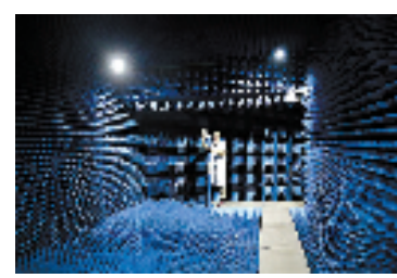
机动车测速仪国家型式评价实验室雷达全做波暗室
