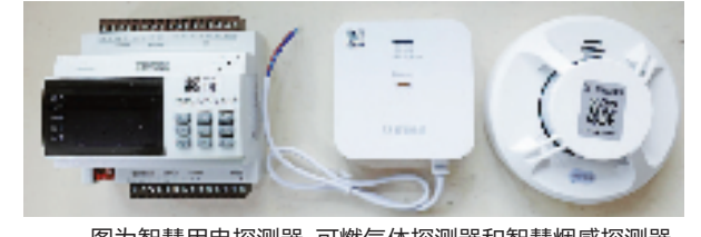
图为智慧用电探测器、可燃气体探测器和智慧烟感探测器。
