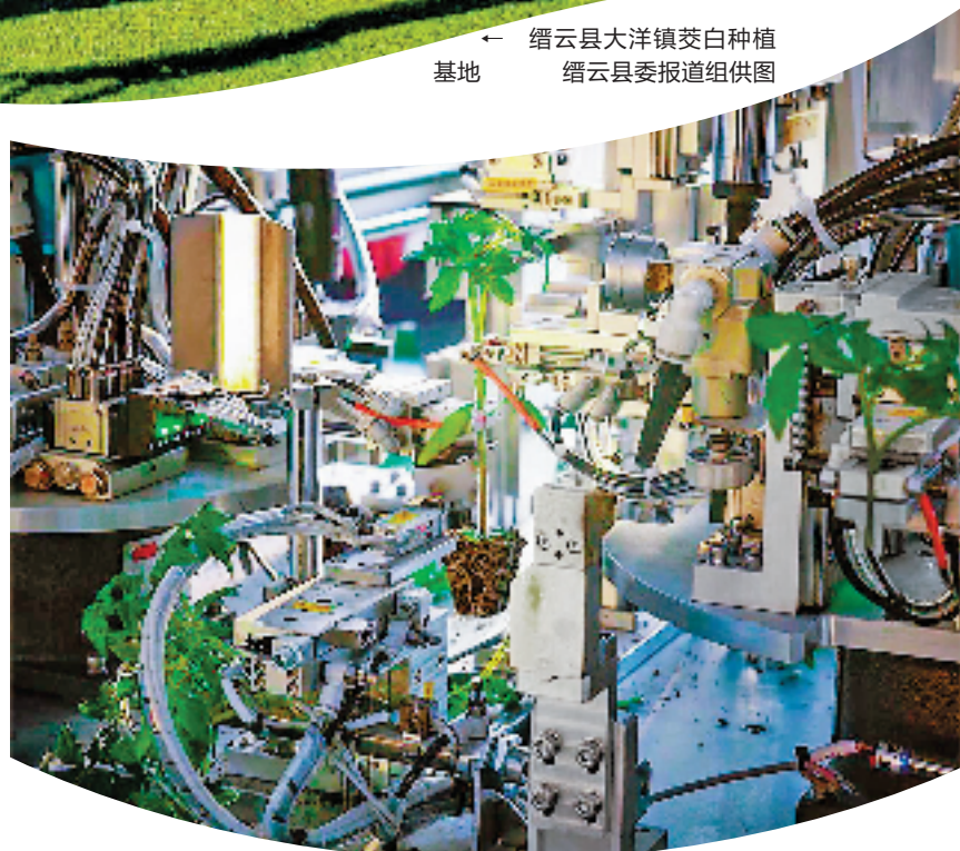
在桐乡市安信数字种苗工厂基地内,自动嫁接机器人正在嫁接植株。 通讯员 叶敏 摄
