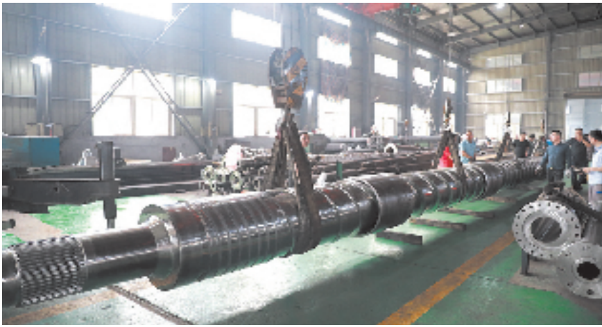
浙江金佳塑料机械有限公司研发的超大型螺杆下线,将于近日发往德国。共享联盟金塘站 张玮 摄
