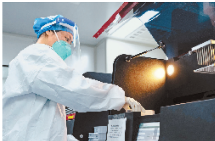
检测人员将加样完成的提取板放置到核酸提取仪进行核酸提取和纯化。
