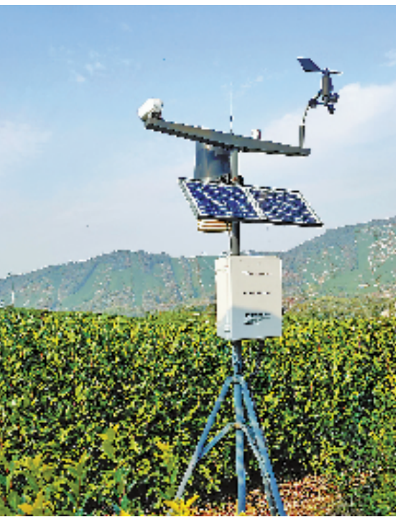
安吉白茶园里的无线农业气象综合监测站设备 安吉县委宣传部供图
