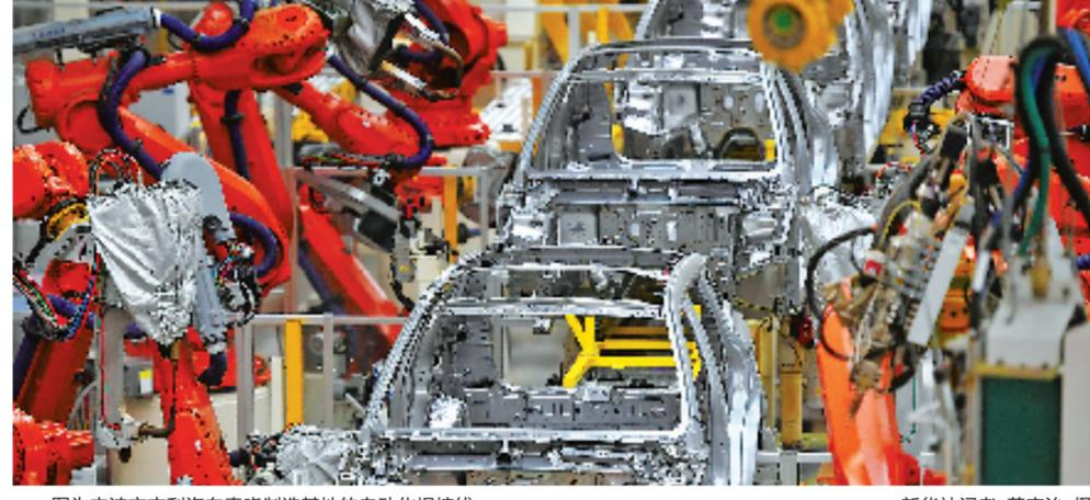
图为宁波市吉利汽车春晓制造基地的自动化焊接线。
