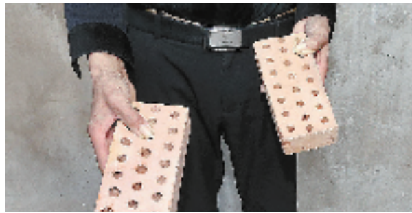
黄立兵用模型制成多孔砖胚并找到砖窑,将这些砖烧制出来。
