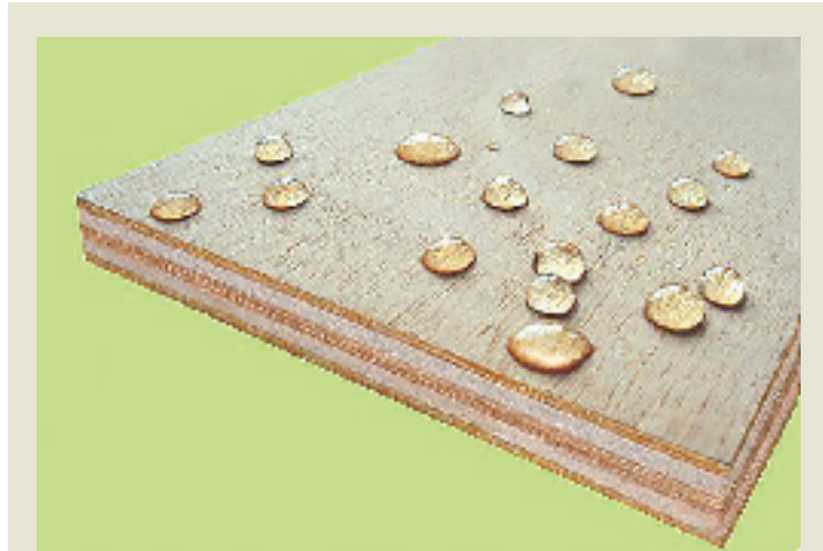
经过真空浸压处理,胶合板像荷叶一样不会沾水。
