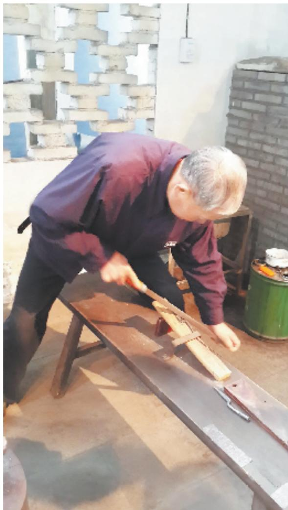
施金水用锉刀将剪刀刃口磨平。
