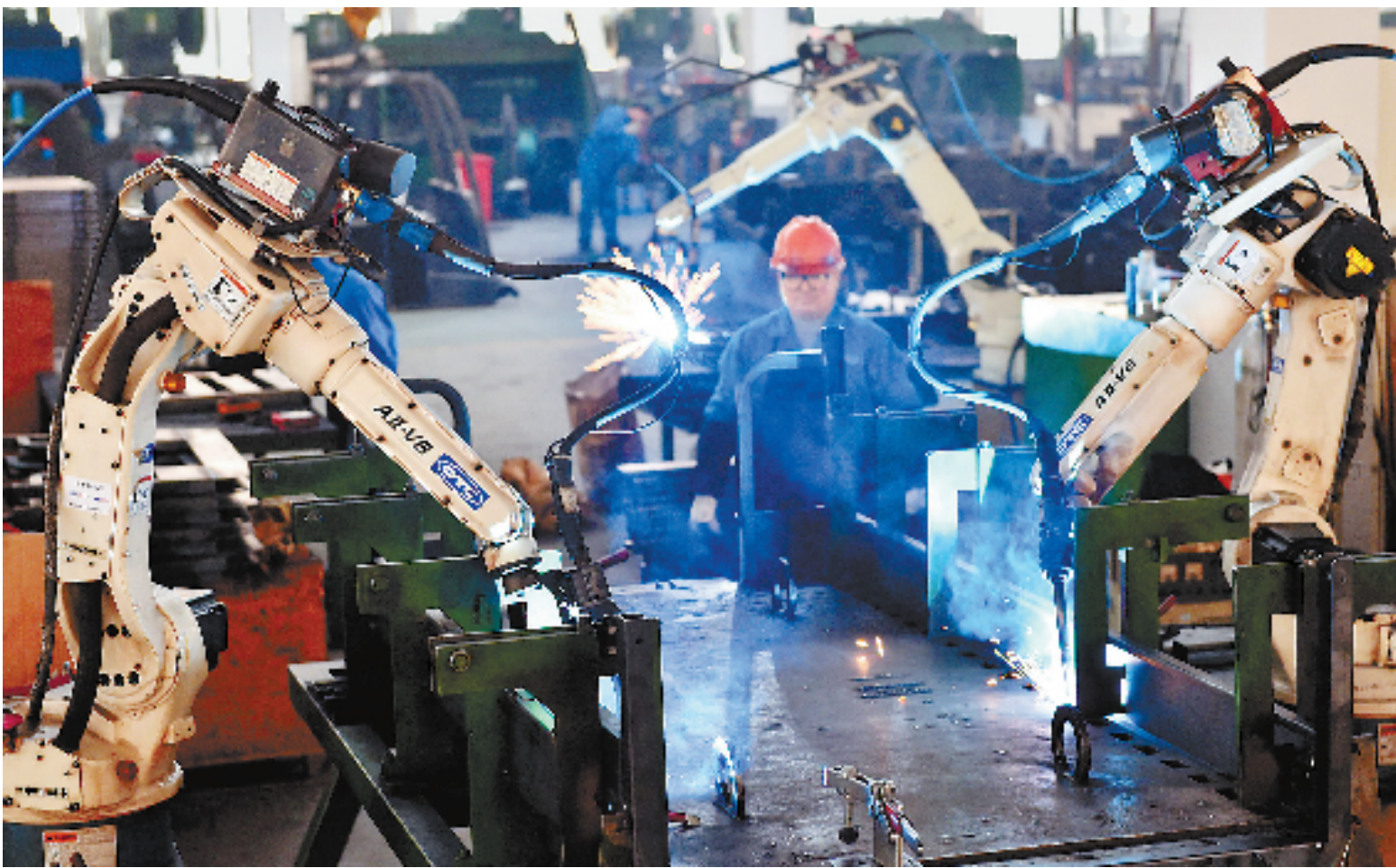
11月9日,在位于德清县雷甸镇的浙江杨明斯金属制品公司,机械臂在生产线上忙碌。该公司今年引进6台机械臂,使总体生产效率提高20%以上,而且焊接工艺更精确、更稳定,提高了产品的优良品率。 梁臻 姚海翔 摄
