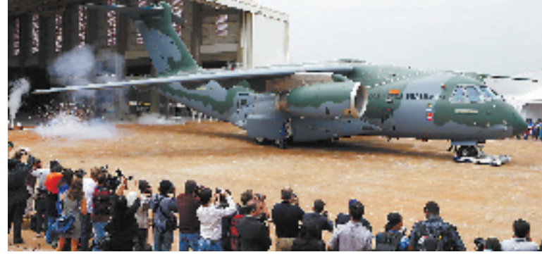
巴西航空工业公司当日在圣保罗州加维昂佩绍图生产基地展示了其生产的最大型运输机KC-390。KC-390是一款用于运送部队和补给的运输机,同时也可执行搜救、森林火灾救援等任务,可运输26吨货物,时速可达870公里。
