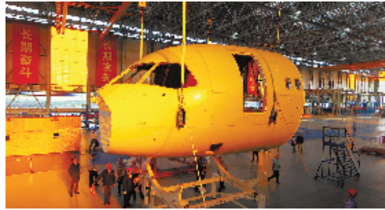
近日,C919国产大型客机首架机头大部段运抵中国商飞公司总装制造中心浦东基地,即将进入机体结构对接程序,同机身进行对合。据悉,C919机头大部段由中国商飞上海飞机设计研究院设计,中航工业成飞飞机制造。新华社发
