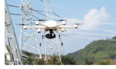
日前,在验收人员的操控下,一架带有高分辨率的六旋翼的无人机腾空而起,在杆塔周围移动、急转、悬停,在操控人员的配合下,装置不停地传来图像和视频数据……这是丽水电力公司检修分公司(输电)开展特高压线路验收工作以来,首次利用无人机配合特高压验收。 洪瑜阳 徐丽勇 摄
