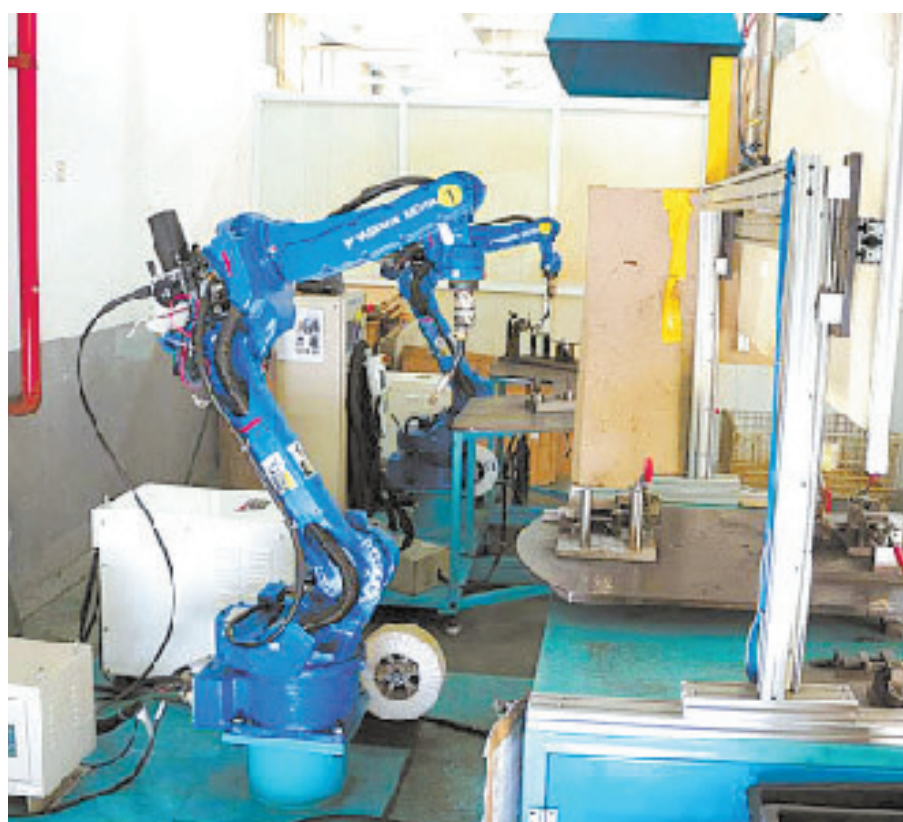
宁波富士汽车部件公司机器人自动焊接生产线
