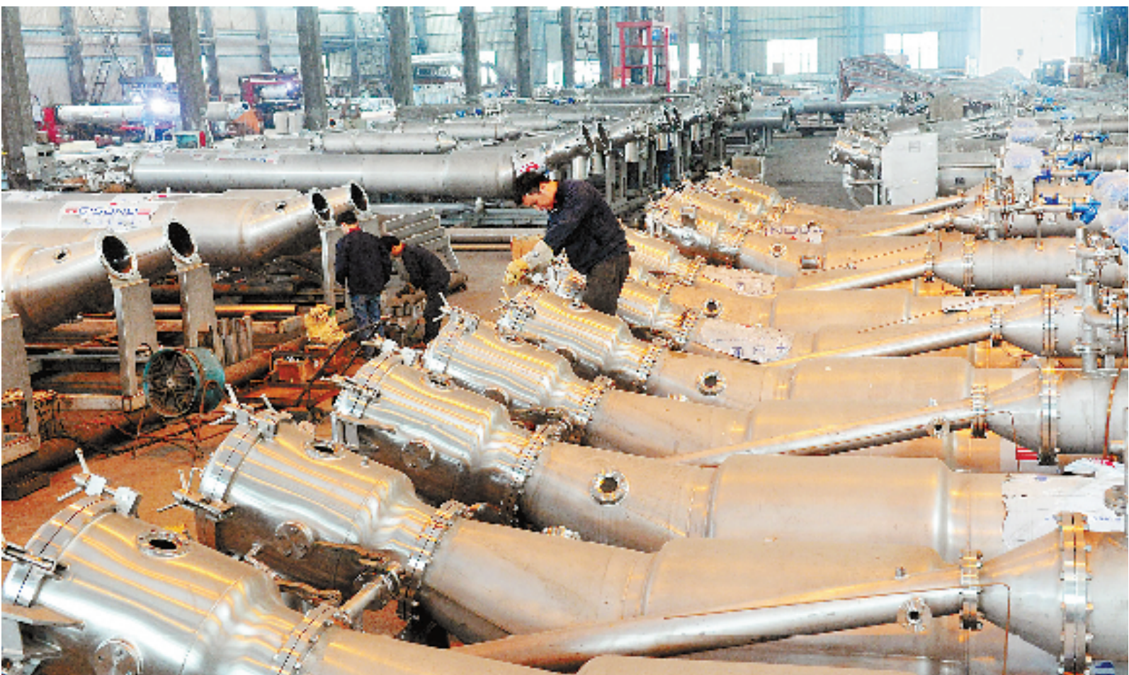
日前,在杭州智能染整设备有限公司车间,员工在生产自主研发的ZNJ高温高压液流染色机。这种“智能染色机”不仅工艺精湛,而且节能减排。 本报记者 吴元峰 摄
